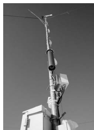
温度計の検定証書(写真左)と下陸別観測所に設置された温度計(写真上、中央の円筒状のもの)
