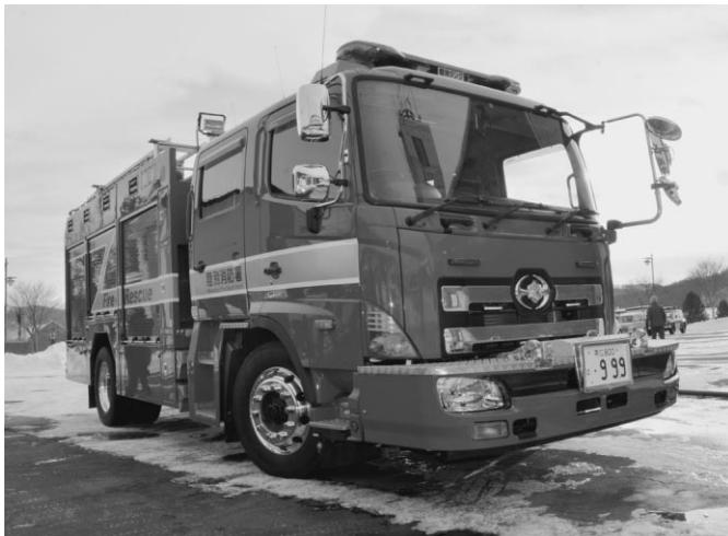
12/25 陸別消防署に新たな消防車が導入され、この日は関係者にお披露目となりました。この消防車は署車であるタンク車を更新したもので、従来の水による消火に加え、同署では初となる消火薬剤による消火活動にも対応しています。また、大型油圧救助器具、照明、ウインチ、三連はしごなども備えていることから、様々な救助活動にも活躍が期待されます。
