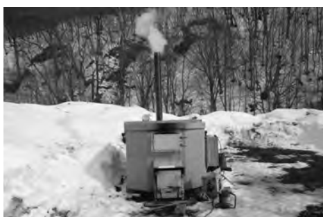
木炭製造試験(3m 3 炭窯:3月実施)
