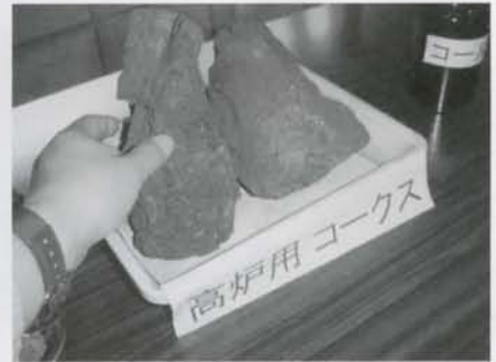
⑯成形品プラの80%は気化し、そのガスでコールタールと軽油になり、残った個体は、高炉用コークスとなりそれぞれ燃料として使用されます。
