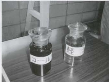
⑯成形品プラの80%は気化し、そのガスでコールタールと軽油になり、残った個体は、高炉用コークスとなりそれぞれ燃料として使用されます。
