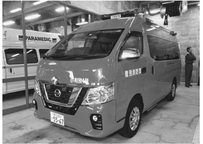
3/1 33年間活躍した陸別消防署の小利別1号車が、新しい小型動力ポンプ付積載車に入れ替えとなり、この日、入魂式が行われました。この車両は、積載している小型動力ポンプの持ち運びが可能のため、車両通行が困難な補水ポイントに運んで消火活動を行うことができます。
